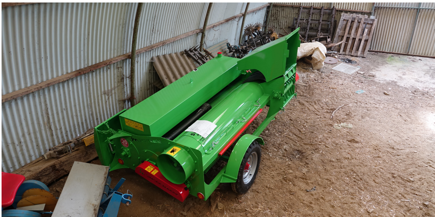
Figure 28. Machine effectuant une extraction mécanique des semences de courges. Origine : Simsek Makina (Turquie).
