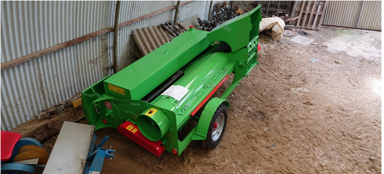
Figure 16. Machine effectuant une extraction mécanique des semences de courges. Origine : Simsek Makina (Turquie).
