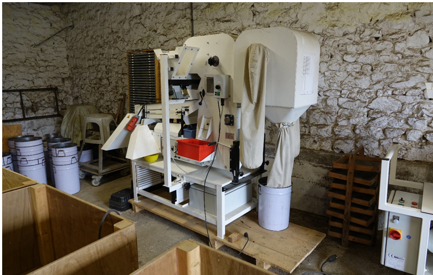
Figure 23. Trieuse de semences. Modèle Mini 80 de chez Reiter Seed Processing GmbH & Co. KG.
