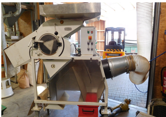
Figure 7. Batteuse à poste fixe utilisée chez Bingenheimer Saatgut AG (modèle Baumann K35).
