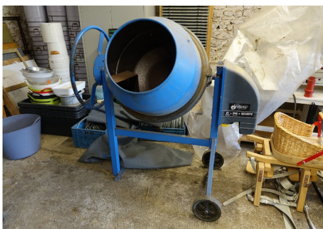
Figure 5. Bétonnière pour le battage de petits lots.
