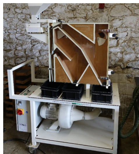
Figure 22. Colonne à air qui était utilisée dans la coopérative Cycle en Terre. Modèle : 4604.10.00 de Seed Processing Holland.
