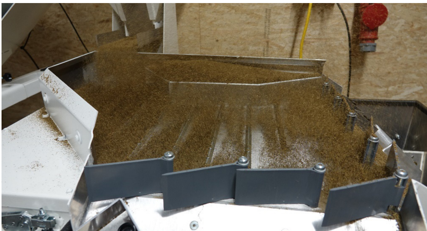
Figure 25. Tests de réglage d'une table densimétrique. Modèle « LAB GA » de chez Reiter Seed Processing GmbH & Co. KG.
