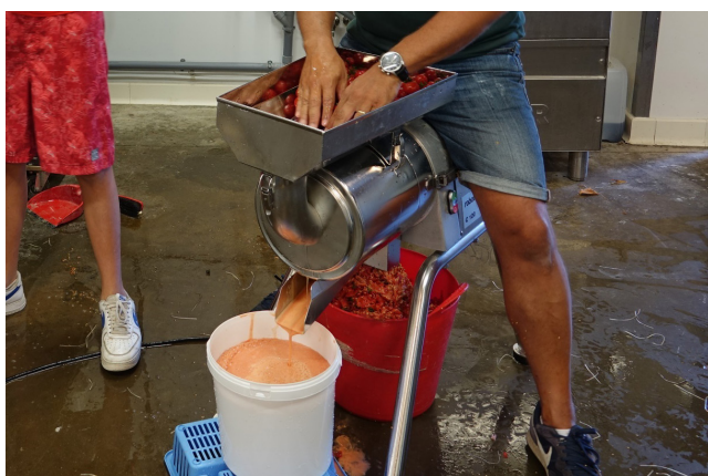
Figure 12. Presse à tomates «Robot Coupe» permettant de gérer de grandes quantités de fruits. Il existe de nombreuses marques de presses de plus petite taille qui conviennent parfaitement.
