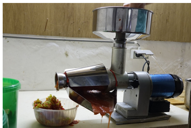
Figure 13. Presse à tomates électrique utile pour l'extraction de semences de tomates.
