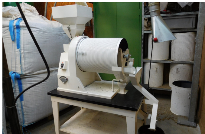
Figure 28. Trieur alvéolaire Westrup. Les différents cylindres sont entreposés dans l'étagère à l'arrière droit de la machine.
