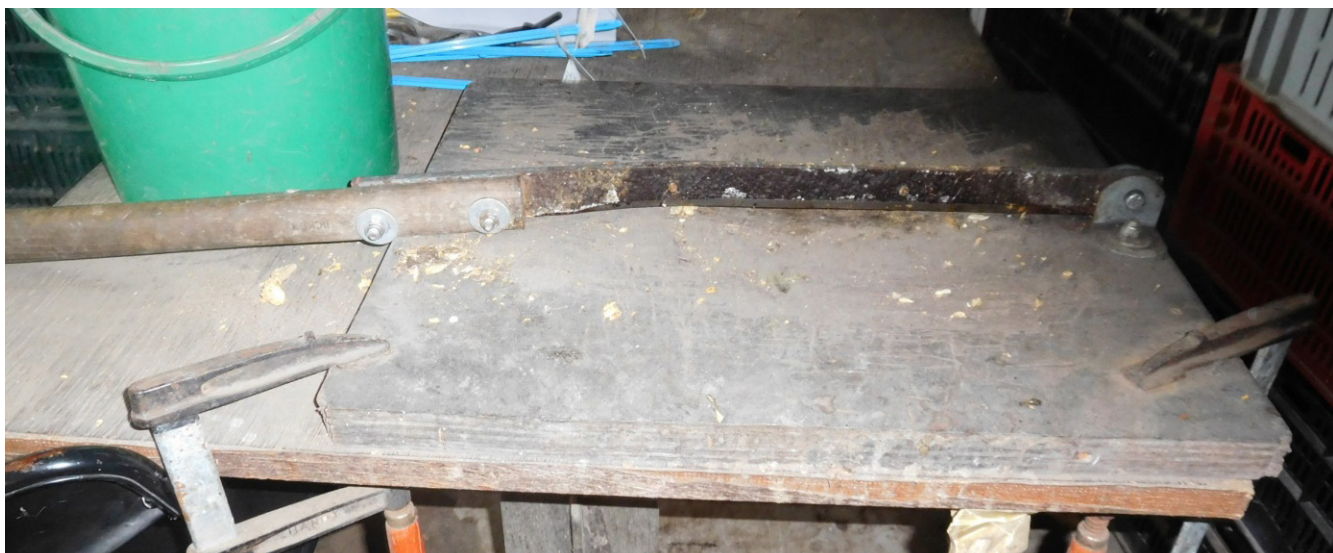
Figure 15. Guillotine à courges, servant à les couper en deux de manière plus rapide qu'avec un couteau dans le but d'extraire ensuite les semences.
