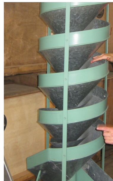
Figure 31. Ancienne spirale de triage chez De Bolster.
