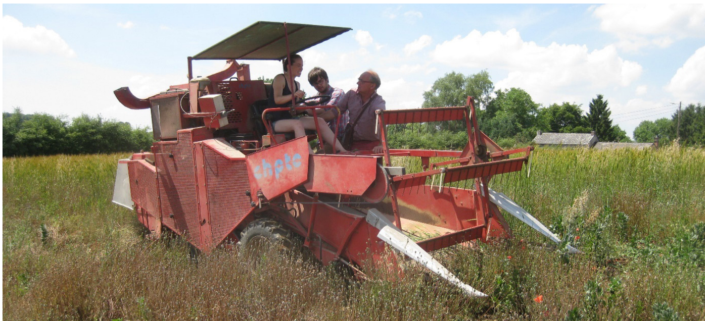
Figure 4. Moissonneuse-batteuse Hégé 140H, datant de 1970.
