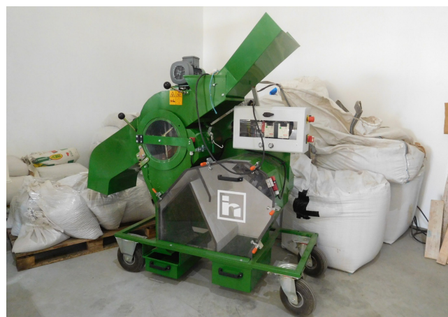
Figure 8. Batteuse de la marque Haldrup utilisée chez Sementes Vivas, au Portugal.
