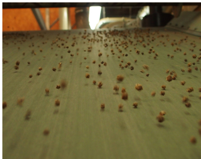
Figure 30. Semences de betteraves dégringolant sur le tapis de triage. Les pailles résiduelles ne roulent pas sur le tapis grâce à sa matière antidérapante. Elles montent jusqu'en haut et sont extraites du lot.
