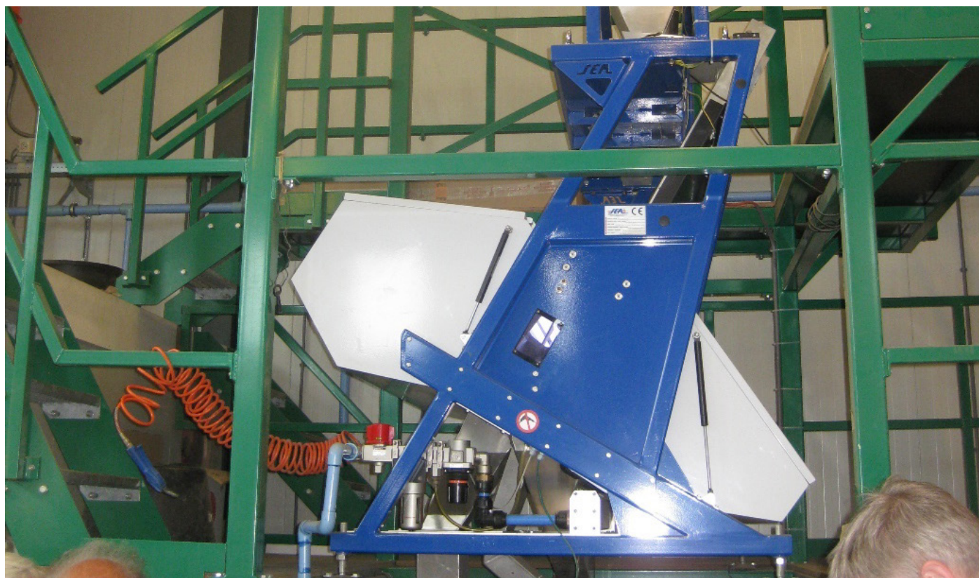
Figure 32. Trieur optique utilisé chez De Bolster.
